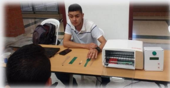
*Control PID para Soldadura de PCB en Horno Tostador*
